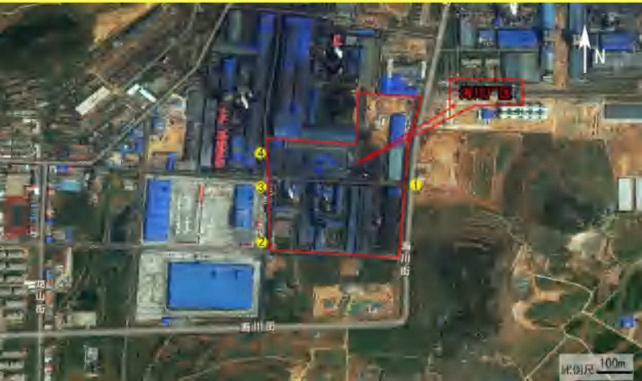
图 2-10 厂界无组织废气监测布点示意图（2022. 8 月）
