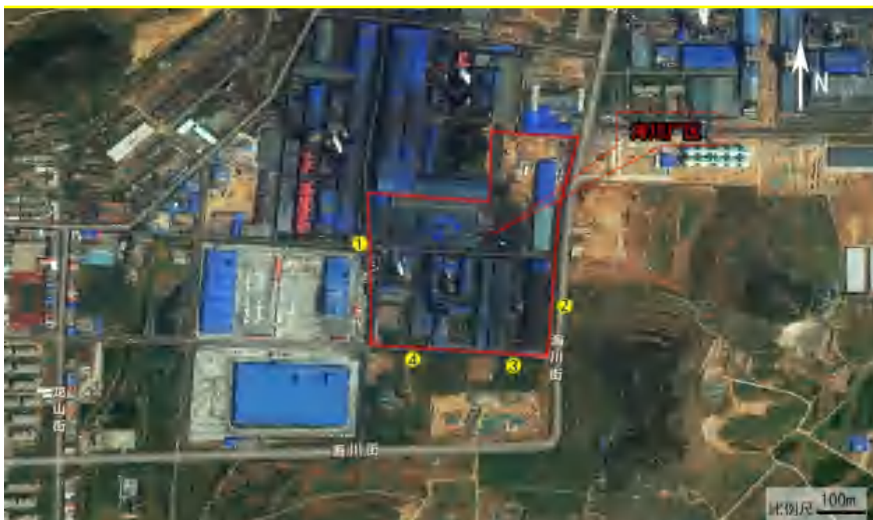
图 2-9 现有厂界无组织废气监测布点示意图（2021.1 月数据）
